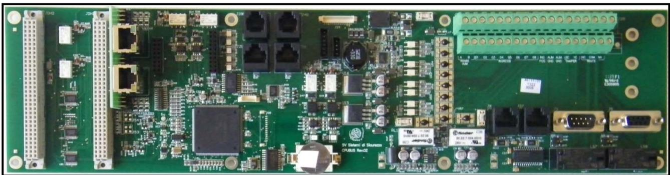
La scheda BUSCPU è una scheda di interfaccia tra EXCPU360, MASTERLCD e il resto del sistema. Consente inoltre di gestire le segnalazioni provenienti dall'alimentatore e fornisce una serie di interfacce per il controllo di:
